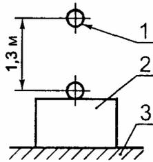
1 - стальной шарик; 2 - светильник; 3 - опорная поверхность
