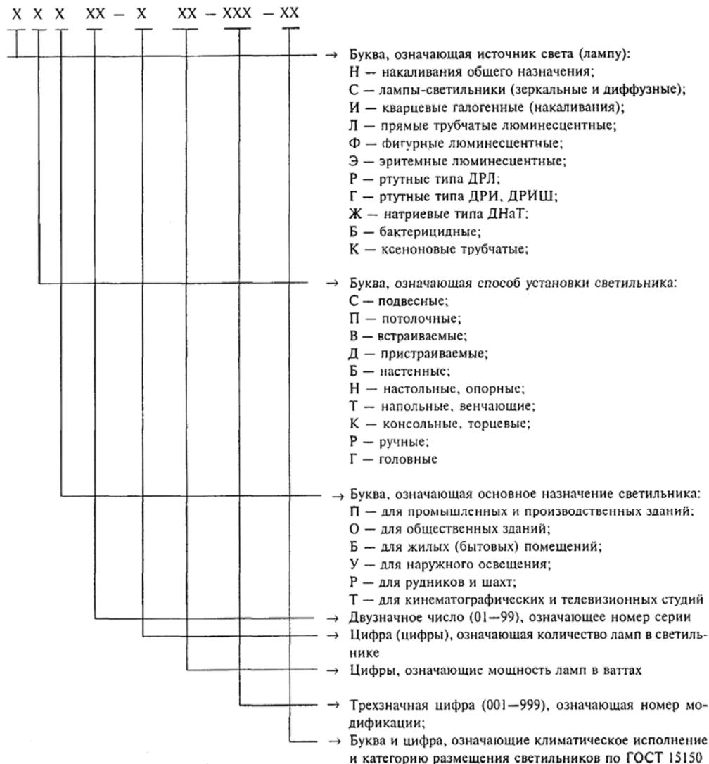
2.2. Условные обозначения светильников, в которых применяют лампы различной мощности или различного типа (например, люминесцентные и накаливания или люминесцентные и эритемные), должны содержать обозначения:
