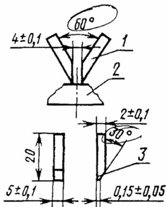
1 - электрод; 2 - испытуемый образец; 3 - конец электрода скруглен
