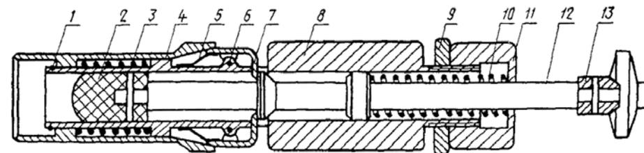
1 - кольцо стопорное; 2 - наконечник; 3 - пружина; 4 - головка; 5 - пружина; 6 - ось; 7 - фиксатор; 8 - корпус; 9 - гайка; 10 - пружина; 11 - колпачок; 12 - шток; 13 - ручка
