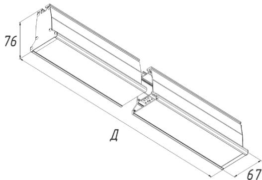
Рисунок 1. Габаритные размеры
